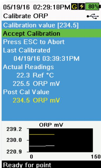
Figura 59 Calibración de ORP
