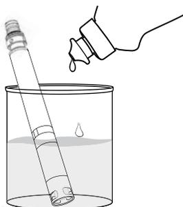
Figura 72 Limpieza del sensor de pH y pH/ORP con jabón para lavar platos
